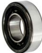
140516 Roller Bearing Nu205etvp2 Replacing: 1900910032 Servicing: 0120600511, 0120600514, 0120600525, 0120600527, 0120600532, 0120600533, 0120600538, 0120600541, 0120600547, 0120600553 O.D. 52.00, I.D. 25.00, H. 15.00
