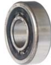
140816 Roller Bearing Nu204etvp2c3 Replacing: 2120910000 Servicing: 0120689519, 0120689529, 0120689536, 0120689537, 0120689544, 0120689547, 0120689554, 0120689556, 0120689560, 0120689589 O.D. 47.00, I.D. 20.00, H. 14.00
